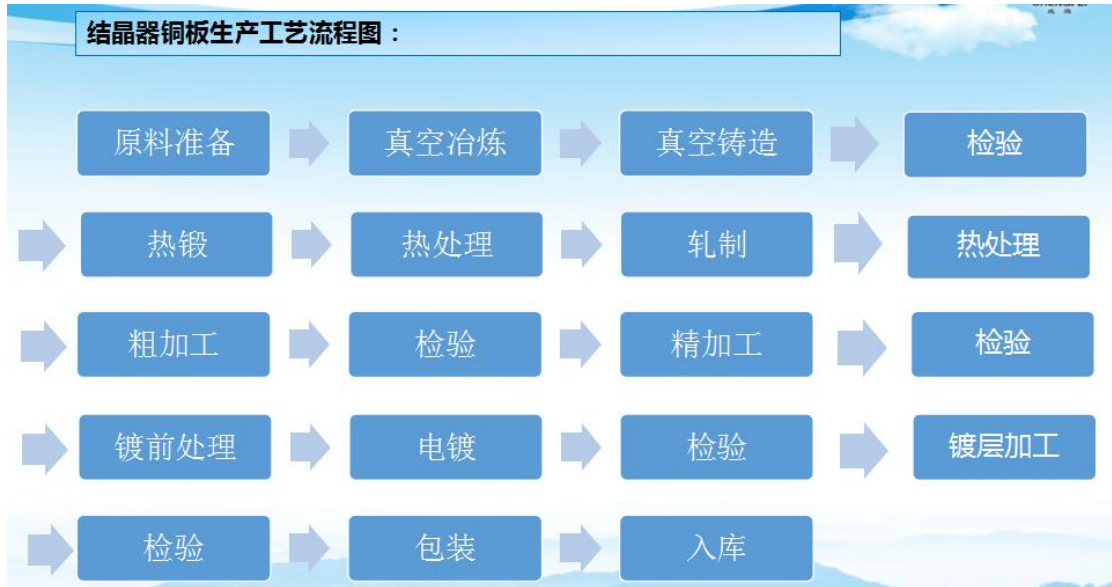
图3-3 结晶器铜板生产工艺流程图
